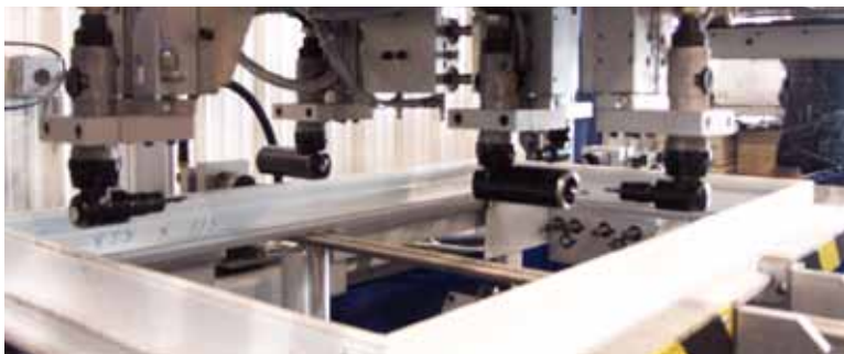
Auto-centrage et serrage automatique des cadres
